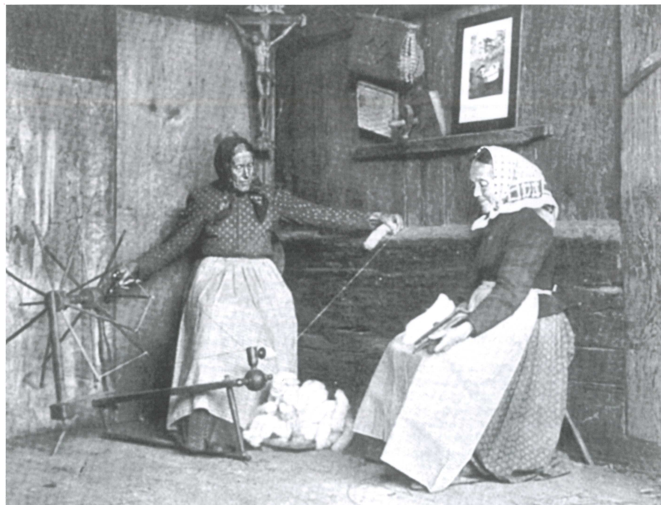
Bereits vor der eigentlichen Industrialisierung des Wiesentals waren die dort ansässigen Menschen mit der Herstellung von Textilien vertraut. Wie im Bild aus der Zeit um 1900 gezeigt, wurde die Wolle in Handarbeit mit Haspel und Kunkel im Wohnzimmer gesponnen und anschließend auf hölzernen Webstühlen zu Stoffen gewoben. Hauptsächlich im oberen Talbereich entstanden so im Laufe der Zeit etliche Hausindustrie-Betriebe. Nach einer Fotografie von M. Ferrars, Freiburg im Breisgau. Vorlage: Der Schwarzwald von Ludwig Neumann, Bielefeld/Leipzig 1911, Seite 27
