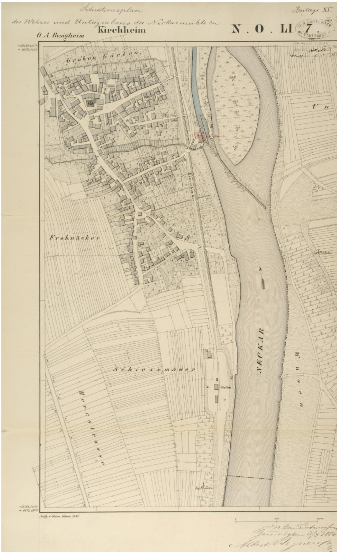
Plan der Mühle in Kirchheim am Neckar von 1884 als Beispiel für die Landvermessung und die Karten 1 : 2000, insbesondere bezüglich Wasserlauf, Wehr und Mühle.
